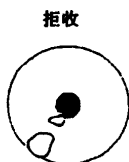
图 2071-3 超过玻璃密封区 1/3 的气泡
