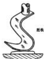
图 2074-7 触须钩形接触
