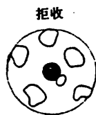
图 2071-1 超过引出端至外壳距 离一半的径向裂缝
